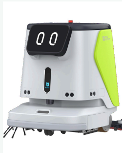
Abbildung: CC1. Der CC1 Pro ist baugleich – die Unterschiede liegen in Sensorik und Software.
