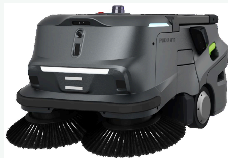
Abbildung: MT1 Monster. Der MT1 Max ist baulich höher gebaut und trägt zusätzlich eine 1,2 m hohe Warnbake.
